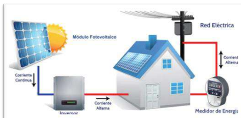
Figura 19: Sistema Fotovoltaico ON GRID 15
